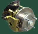
4 tekerlek hidrolik disk fren, elektronik park freni, yokus kalkış desteği (Auto hill hold)
