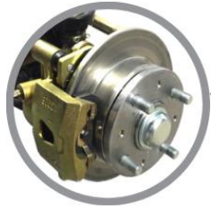
4 tekerlek hidrolik disk fren, elektronik park freni, yokuş kalkış desteği (Auto hill hold)
